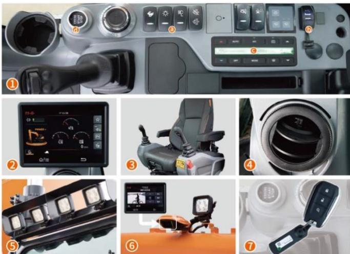
1. Централизованная конструкция переключателей с функциональными клавишами
